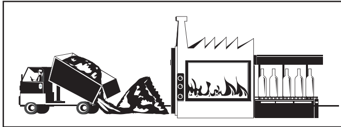
Le calcin est transporté vers l'usine verrière où il est utilisé pour fabriquer de nouveaux emballages en verre.
