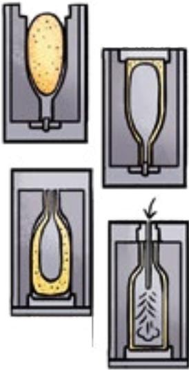
Pour une bouteille, qui est un verre creux, la forme est obtenue par soufflage d'air.
