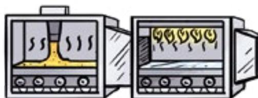
• **La fibre de verre**, qui entre dans la composition des coques de bateau, des pales d'éoliennes ou des skateboards, est obtenue par centrifugation d'un filet de verre (en bobine ou fil coupé).
